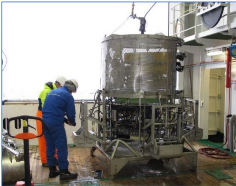
Figur 5. VAMS-enheten på dekket på G.O. Sars. ROVen står i garasje i øvre etasje.
