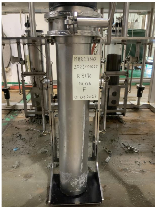
Figur 5. Sedimentkjerne «F» stående i MC-prøvetakeren tatt i stålrør på stasjon R3196 i KB øst for Utsira Nord på tokt 2023001005. For bilde av multicorerer se Figur 3. Gul-lappen er 7,5x12,5 cm.
