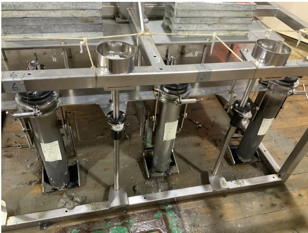
Figur 3. Multicorer med seks rør, hvorav to sedimentkjerne i gjennomsiktige PVC-rør går til kjemiske analyser og to sedimentkjerne i stålør i midten går til mikroplastanalyse. Prøvetakingen på bildet er fra stasjon R3188, KB øst for Utsira Nord, tokt 2023001005.
