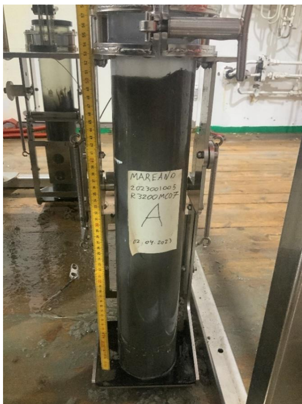
Figur 4. Sedimentkjerne «A» stående i MC-prøvetakeren tatt i PVC-rør på stasjon R3200 i Kystbeltet øst for Utsira Nord, tokt 2023001005. Røret er 60 cm langt og sedimentkjerne med uforstyrret overflate har en klar vannsøyle over sedimentene. Dermed er kjernen godkjent for bruk til uorganiske kjemiske analyser. For bilde av multicorerer se Figur 3.
