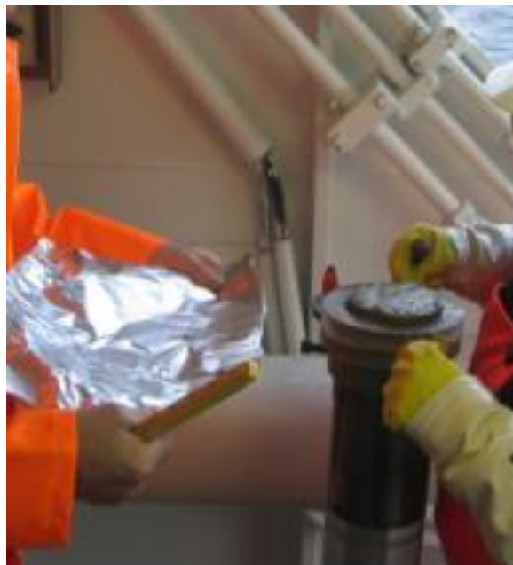
Figur 5. Øverste 1 cm av sediment-kjerne stikker opp av kjerneskiver. Overflate prøve for organiske analyser.
