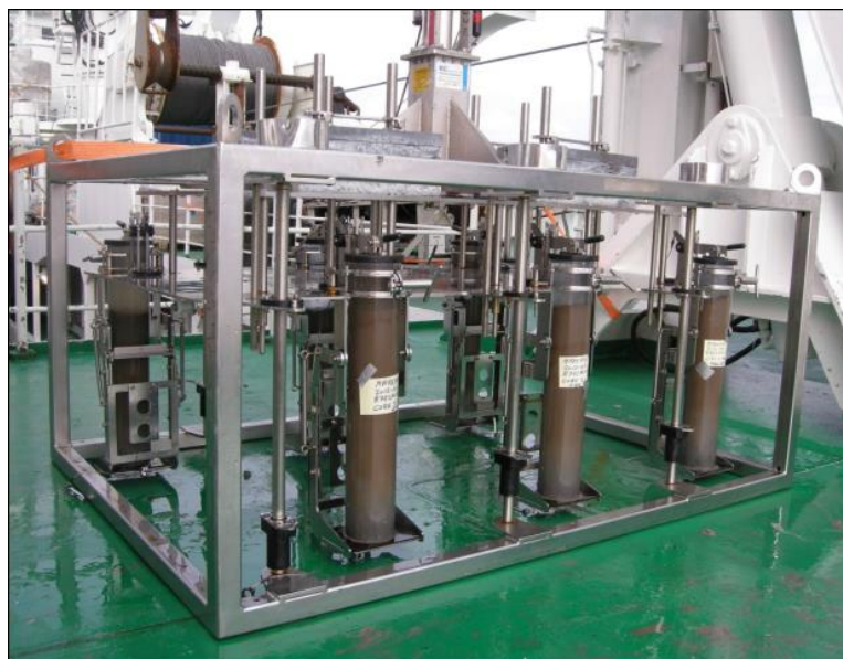
Figur 1. Bildet viser multicorer på dekk etter prøvetaking. Skissen viser dimensjoner og relativ plassering av 6 kjerner.
