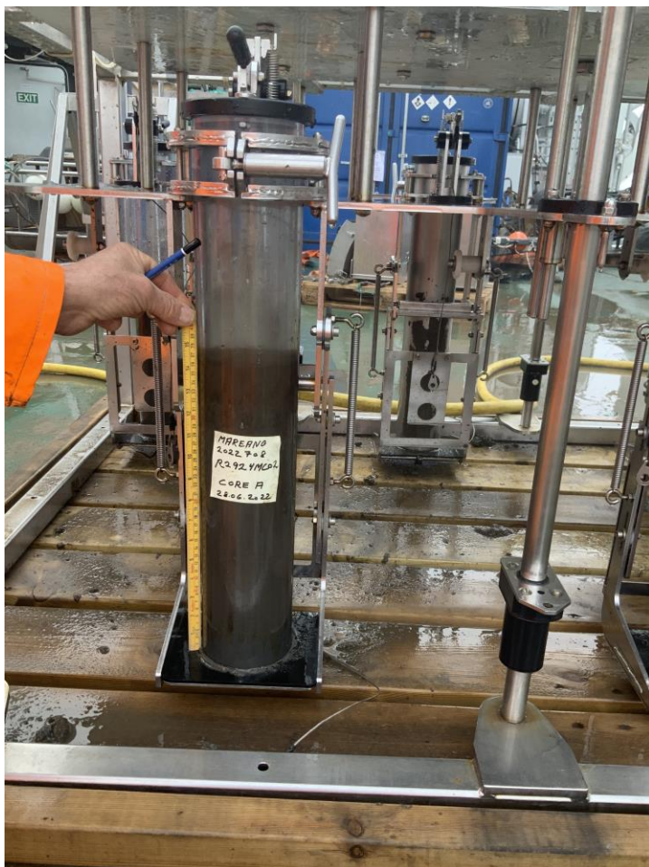
Figur 9: Merking og måling av lengde på sedimentkjerne. Kilde: NGU/Mareano.
