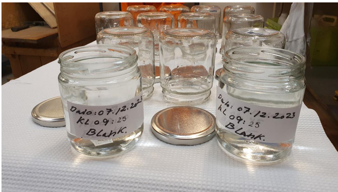
Figur 13: Blankprøver til langtidseksponering og glass forberedt til prøvetaking. Kilde: NGU.
