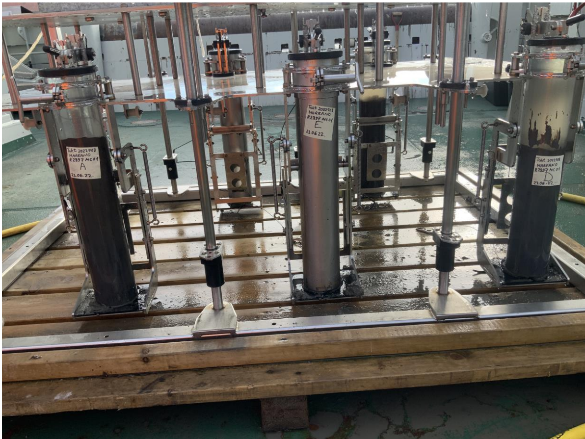
Figur 3. Multicorerer på dekk etter prøvetaking og merking av rørene. Kilde: NGU/Mareano.
