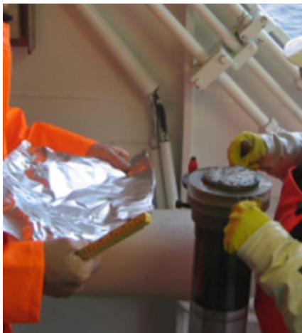
Figur 12: Overflateprøve for organiske analyser. Øverste 1 cm av sedimentkjerne stikker opp av kjerneskiver. Kilde: Mareano tokt 2008/ NGU/Mareano.
