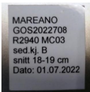
Figur 8: Eksempel på prøvemerking. Bildet viser opplysninger som følger med prøven. Kilde: HI.
