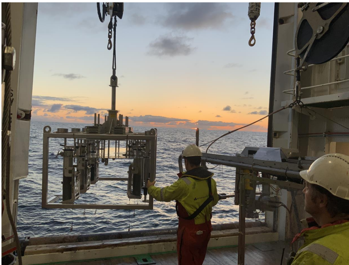
Figur 2: Multicorerer på vei inn etter prøvetaking tatt på tokt mai – juni 2021, stasjon R2669 fra ytre Vestfjorden. Kilde: NGU/Mareano.
