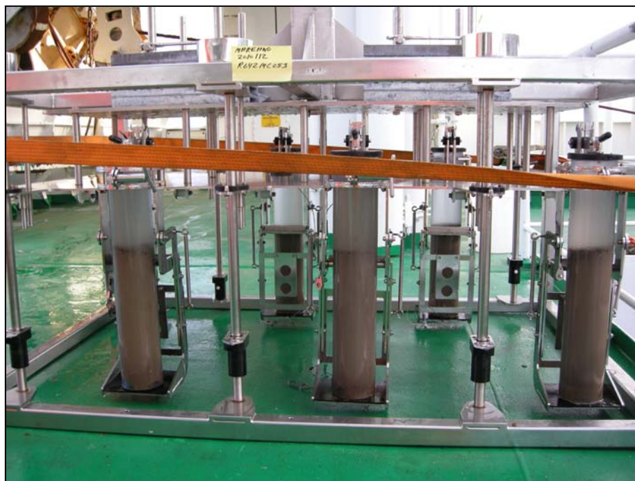
Figur 3. Multicorer med 6 sedimentkjerper på dekk. Prøvetaking på stasjon R642 (2352 m havdyp), Nordland VI dyphavsslette. Lengdene på de 6 sedimentkjernene varierer fra 33 cm til 39 cm.
